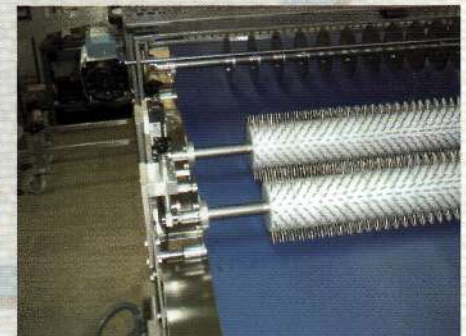
Устройство резки и перфорации тестовых заготовок
