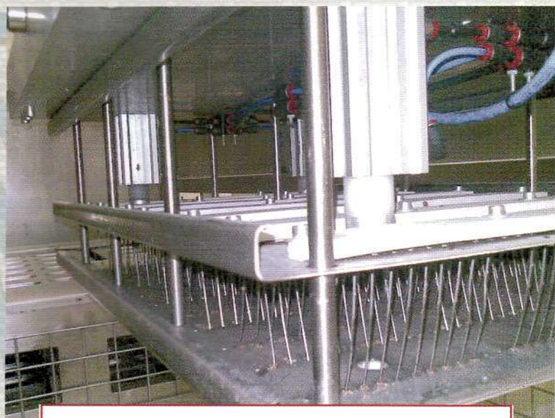
Робот для перекладки готовых кондитерских изделий с производственной линии на линию упаковки
