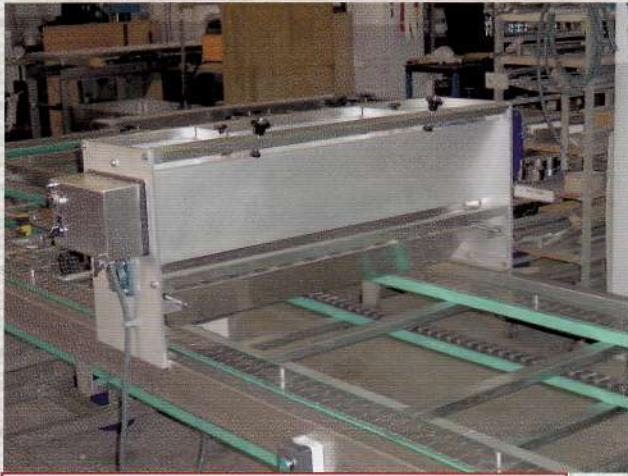
Дозатор посыпки полуфабрикатов сыпучими ингредиентами
