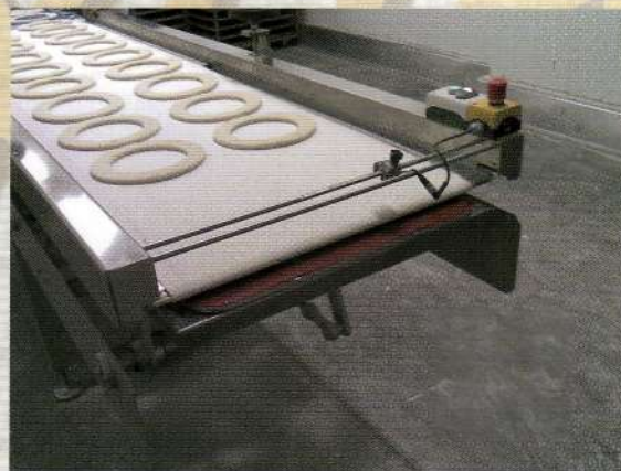
Транспортёр для автоматической перекладки тестовых заготовок с линии приготовления и формования теста на противни для выпечки изделий
