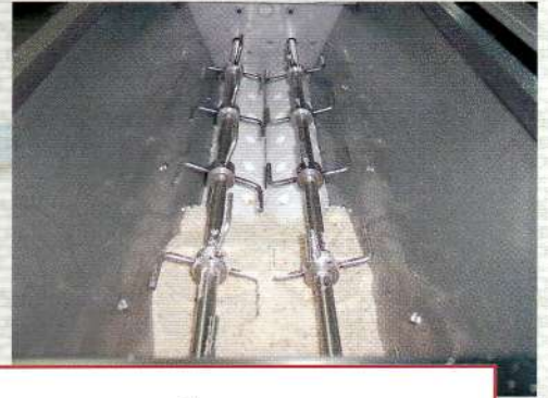
Внутренняя часть бункера дозатора посыпки: перемешиватели и дозирующие валы
