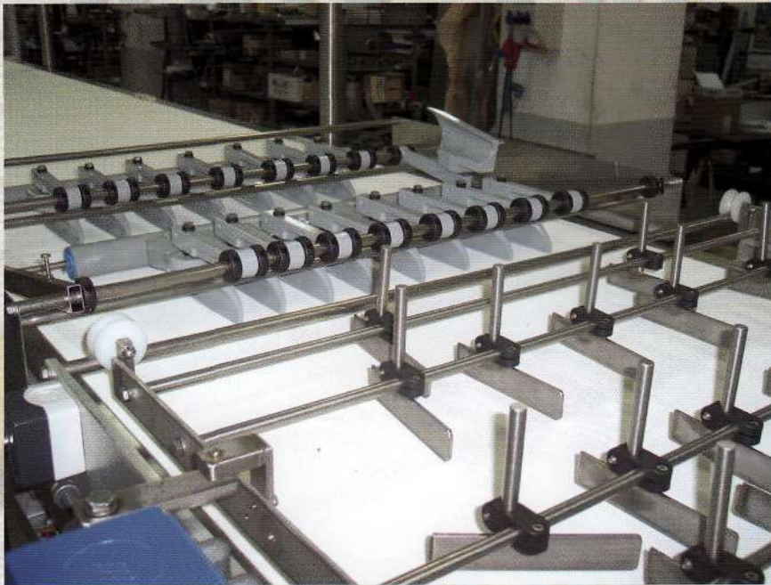
Устройство калибровки толщины пласта теста в составе автоматической производственной линии
