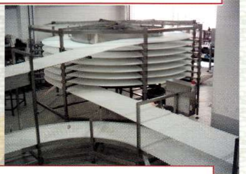
Вариант спирального транспортёра. Служит для естественного охлаждения или аккумуляции продукции
