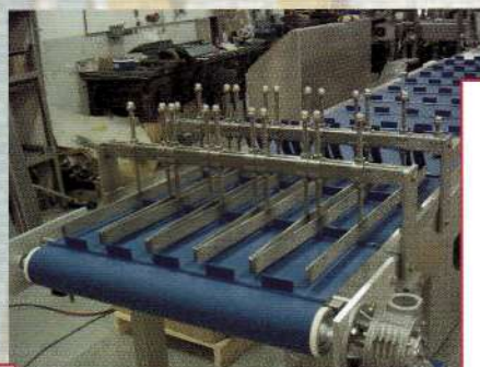
Транспортёр для разделения и выравнивания тестовых заготовок в составе автоматической линии
