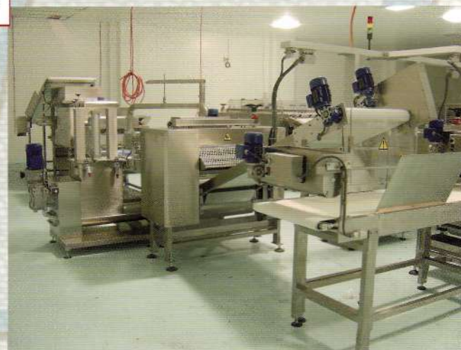
Линия подготовки слоёного тестового пласта для формования круассанов
