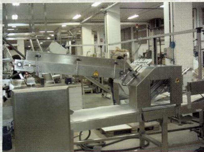
Устройство нарезки и автоматической закладки между слоями теста тонких пластин из брикета сливочного масла. Устройство используется в составе автоматической линии приготовления слоёного теста
