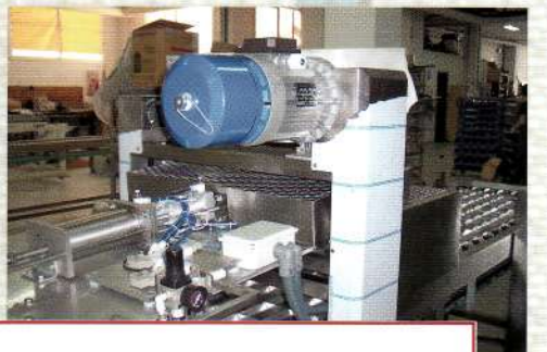
Дозатор пастообразных ингредиентов
