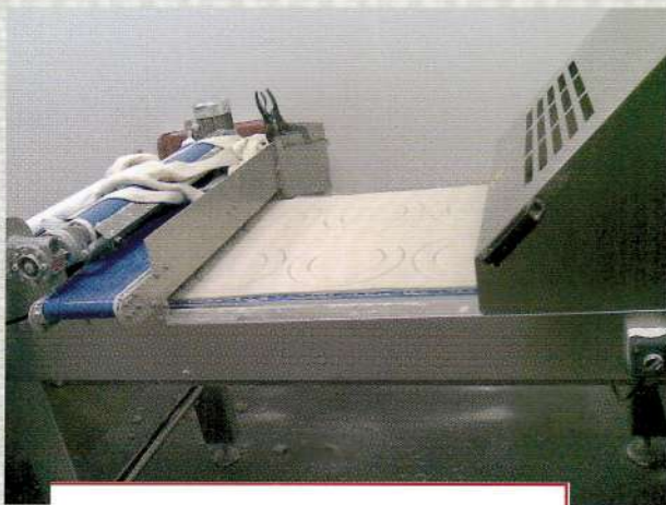
Устройство отделения обрезков теста
