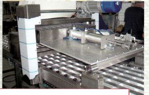
Дозатор пастообразных ингредиентов
