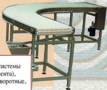
Конвейерные системы для перемещения подносов в заданном направлении, в том числе с изменением расстояния между подносами для синхронизации с дополнительным оборудованием.
