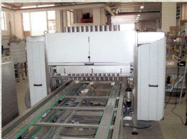
Капсулятор - устройство для автоматической установки бумажных капсул для заполнения их тестом (и другими полуфабрикатами) на производственную линию
