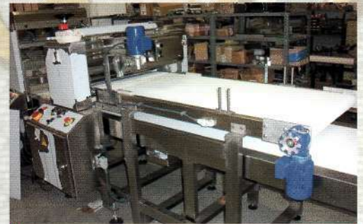
Устройство калибровки толщины пласта теста в составе автоматической производственной линии
