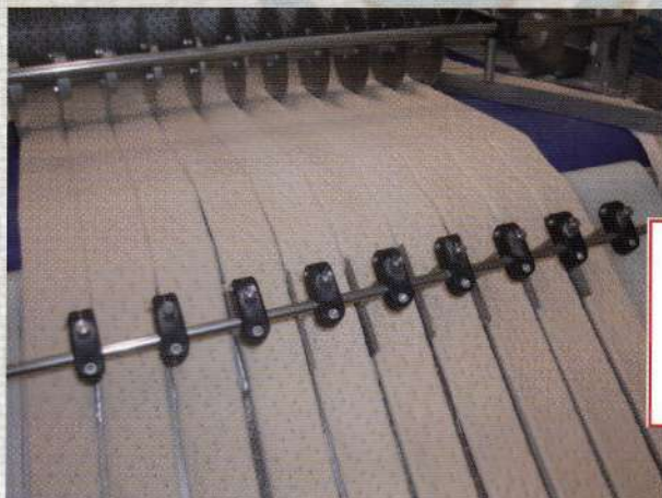
Разделитель тестовых полос после резки в составе автоматической линии для производства кондитерского изделия "Панини"
