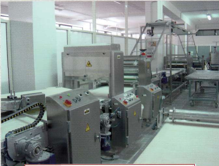
Линия подготовки тестового пласта (линия ламинации)
