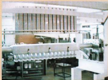
Машина для укладки капсул под магдаленки. Адаптируется под различные печи.
