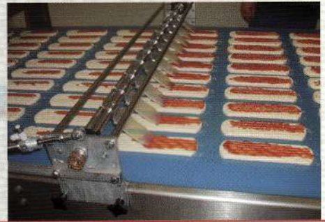
Устройство "размазывания" начинки на тестовой заготовке
